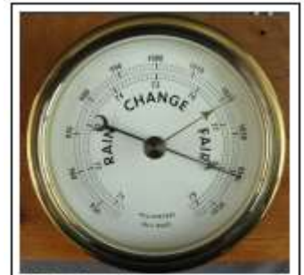
El barómetro es el instrumento que se utiliza para medir la presión atmosférica. Imagen cedida por Langspeed.
